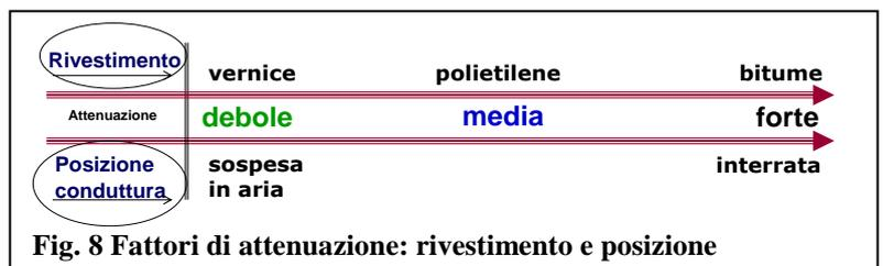
Fig. 8 Fattori di attenuazione: rivestimento e posizione
